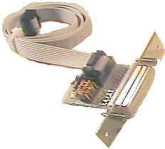
NCS 281 ist der RS232 Anschlussadapter für die Platinen NCS 202 / 3 / 4 und NCS 208. Er hat die gleiche Baugröße wie ein 50 poliger Centronics Steckverbinder und passt somit in den Standard Durchbruch bei Philips Steuerungen.
